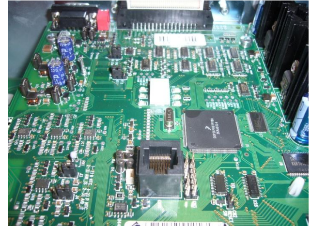
Schede eletroniche di comant dentri un convertidôr cc / ca o inverter
