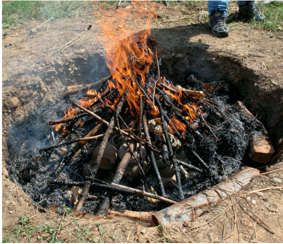
Taponin i manufats cuntune tasse di lens e impiin il fûc. Cumò lis nestrîs ceramichis a cuein a 700-800° C.
